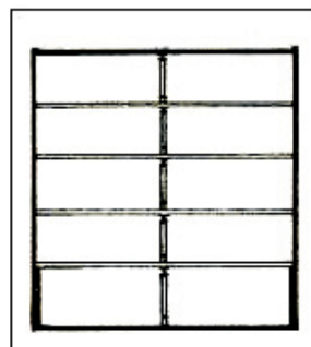
Flervåningsbyggnad: gjutjärnspelare & stålbalkskonstruktion: A-Fabriken
